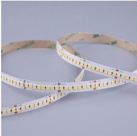
Ruban LED de la série PERFORMANCE. Le ruban se distingue par un effet d'éclairage uniforme grâce à l'utilisation d'une courte distance entre les LED. Le ruban est composée de 240 LED par mètre avec une puissance de 15W/m et a une classe énergétique D. Convient aux environnements intérieurs et secs: IP20. Rouleau de 5m. Le ruban de LED est contrôlée par une tension de 24Vdc. Le ruban fournit 2000 Lm/m et a une température de couleur de 3000K avec un IRC de >90. Le ruban est dimmable via PWM.
