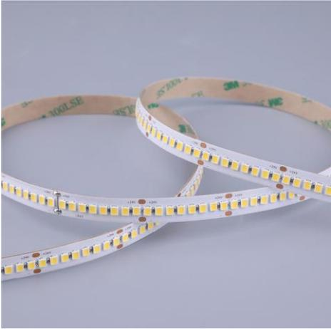
Ruban LED de la série PERFORMANCE. Le ruban se distingue par un effet d'éclairage uniforme grâce à l'utilisation d'une courte distance entre les LED. Le ruban est composée de 240 LED par mètre avec une puissance de 15W/m et a une classe énergétique C. Convient aux environnements intérieurs et secs: IP20. Rouleau de 5m. Le ruban de LED est contrôlée par une tension de 24Vdc. Le ruban fournit 2000 Lm/m et a une température de couleur de 4000K avec un IRC de >90. Le ruban est dimmable via PWM.
