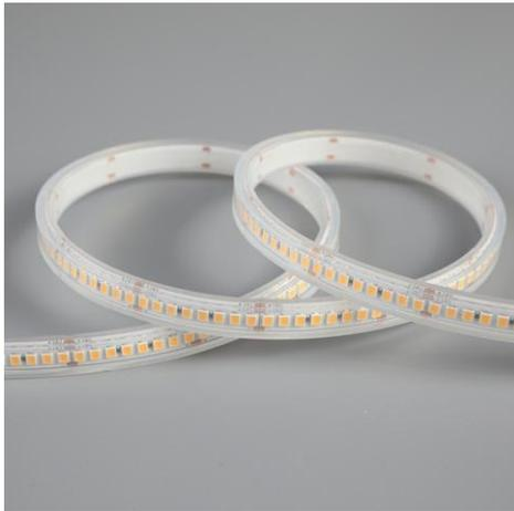
Ruban LED de la série PERFORMANCE. Le ruban se distingue par un effet d'éclairage uniforme grâce à l'utilisation d'une courte distance entre les LED. Le ruban est composée de 240 LED par mètre avec une puissance de 15W/m et a une classe énergétique D. Convient aux environnements extérieurs et humides: IP67. Rouleau de 5m. Le ruban de LED est contrôlée par une tension de 24Vdc. Le ruban fournit 2000 Lm/m et a une température de couleur de 2700K avec un IRC de >90. Le ruban est dimmable via PWM.
