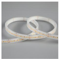
Ruban LED de la série PERFORMANCE. Le ruban se distingue par un effet d'éclairage uniforme grâce à l'utilisation d'une courte distance entre les LED. Le ruban est composée de 240 LED par mètre avec une puissance de 17W/m et a une classe énergétique D. Convient aux envirronements extèrieurs et humides: IP67. Rouleau de 5m. Le ruban de LED est contrôlée par une tension de 24Vdc. Le ruban fournit 2500 Lm/m et a une température de couleur de 3000K avec un IRC de >90. Le ruban est dimmable via PWM.
