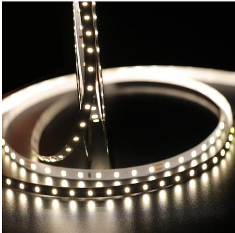
Ruban LED de la série PERFORMANCE. Le ruban se distingue par son rendement élevé, est composée de 240 LED SMD par mètre avec une puissance de 25W/m et a une classe énergétique E. Convient aux environnements intérieurs et secs: IP20. Rouleau de 5m. Le ruban de LED est contrôlée par une tension de 24Vdc. Le ruban fournit 3000 Lm/m et a une température de couleur de 3000K avec un IRC de 80. Le ruban est dimmable via PWM.
