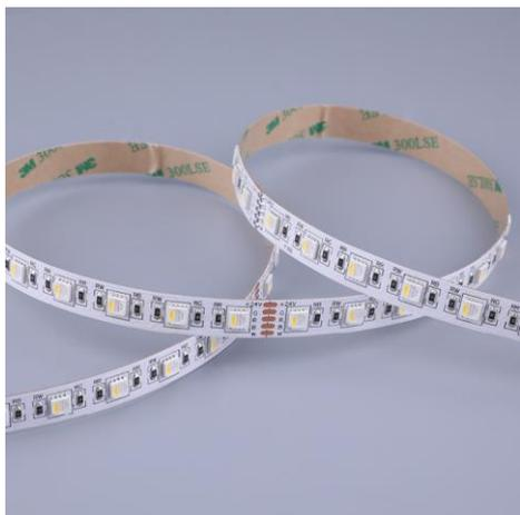
Ruban LED multicolore RGB-W de la série PERFORMANCE. Le ruban est composée de 224 LED SMD par mètre avec des LEDs séparés pour le couleur blanc. Le ruban a une puissance de 19,2W/m et une classe énergétique E. Convient aux environnements intérieurs et secs: IP20. Rouleau de 5m. Le ruban de LED est contrôlée par une tension de 24Vdc. Le ruban fournit 1360 Lm/m et a une température de couleur de 2700K avec un IRC de >90. Le ruban est dimmable via PWM.
