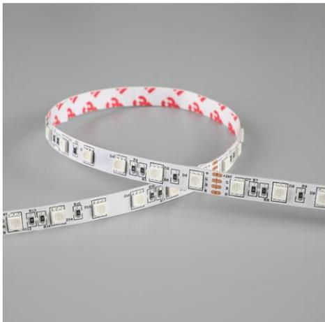
Ruban LED multicolore RGB de la série PERFORMANCE. Le ruban est composée de 224 LED SMD par mètre. Le ruban a une puissance de 20W/m et une classe énergétique G. Convient aux environnements intérieurs et secs: IP20. Rouleau de 5m. Le ruban de LED est contrôlée par une tension de 24Vdc. Le ruban fournit 760 Lm/m et a une température de couleur de RGBK avec un IRC de >. Le ruban est dimmable via PWM.
