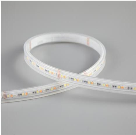
Ruban LED multicolore RGB-TW de la série PERFORMANCE. Le ruban est composée de 288 LED SMD par mètre avec des LEDs séparés pour le couleur blanc. Le blanc varie de 2200K à 6500K. Le ruban a une puissance de 18W/m et une classe énergétique F. Convient aux environnements extérieurs et humides: IP67. Rouleau de 5m. Le ruban de LED est contrôlée par une tension de 24Vdc. Le ruban fournit 1433 Lm/m avec un IRC de >90. Le ruban est dimmable via PWM.
