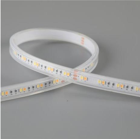
Ruban LED monocolore TW de la série PERFORMANCE. La ruban est composée de 224 LED SMD par mètre. Le température de couleur varie de 2200K à 6500K. Le ruban a une puissance de 20W/m et une classe énergétique F. Convient aux environnements extérieurs et humides: IP67. Rouleau de 5m. Le ruban de LED est contrôlée par une tension de 24Vdc. Le ruban fournit 1718 Lm/m avec un IRC de >90. Le ruban est dimmable via PWM.
