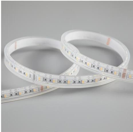
Ruban LED multicolore RGB-W de la série PERFORMANCE. Le ruban est composée de 224 LED SMD par mètre avec des LEDs séparés pour le couleur blanc. Le ruban a une puissance de 17W/m et une classe énergétique E. Convient aux environnements extérieurs et humides: IP67. Rouleau de 5m. Le ruban de LED est contrôlée par une tension de 24Vdc. Le ruban fournit 1345 Lm/m et a une température de couleur de 4000K avec un IRC de >90. Le ruban est dimmable via PWM.
