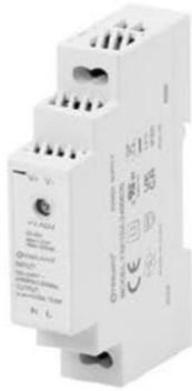
Alimentation ruban LED Constant Voltage, classe 2 en boîtier plastique. Primaire 198-264VAC, secondaire 24VDC 15W. Boîtier Din-Rail 1 module (largeur module) IP20, dimmable par contrôle externe. Protégé contre courts-circuits, surcharges et surtension.
