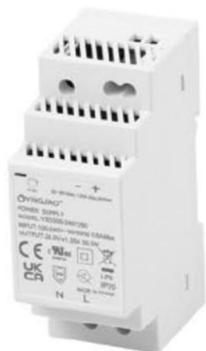
Alimentation ruban LED Constant Voltage, classe 2 en boîtier plastique. Primaire 198-264VAC, secondaire 24VDC 30W. Boîtier Din-Rail 2 modules (largeur module) IP20, dimmable par contrôle externe. Protégé contre courts-circuits, surcharges et surtension.
