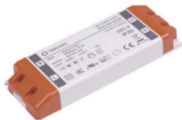
Alimentation ruban LED Constant Voltage, classe 2 en boîtier plastique. Primaire 198-264VAC, secondaire 24VDC 40W. Equipé de connexions câbles vissables. IP20, dimmable par contrôle externe. Protégé contre courts-circuits, surcharges et surtension.
