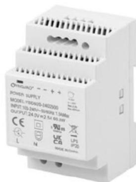
Alimentation ruban LED Constant Voltage, classe 2 en boîtier plastique. Primaire 198-264VAC, secondaire 24VDC 60W. Boîtier Din-Rail 3 modules (largeur module) IP20, dimmable par contrôle externe. Protégé contre courts-circuits, surcharges et surtension.
