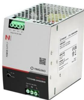
Alimentation ruban LED Constant Voltage, classe 1 en boîtier plastique. Primaire 90-264VAC, secondaire 48VDC 480W. Boîtier Din-rail 4,5 modules (largeur module), IP20, dimmable par contrôle externe. Protégé contre courts-circuits, surcharges et surtension
