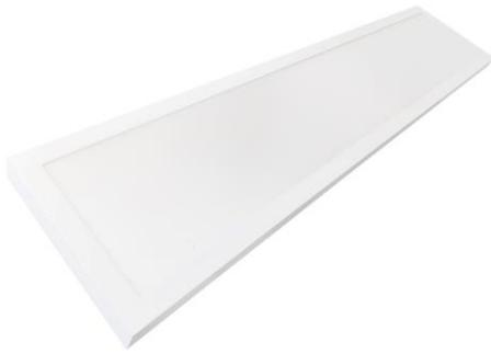
QUADRA kit de panneau LED 325x1225mm comprenant un cadre en aluminium blanc RAL9016 monté en surface et équipé d'un support de suspension en métal pour un montage facile. Inclut un driver dont la puissance est sélectionnable entre 24W, 29W, 35W ou 41W et la température de couleur 3000K, 4000K ou 5000K via des dipswitches. Le panneau LED backlit a une efficacité jusqu'à 140 Lm/W et grâce au diffuseur microprismatique un UGR<19. Cet ensemble est approuvé par l'ENEC.
